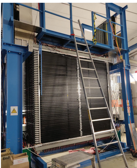
Neutronski detektor NeuLAND na institutu GSI/FAIR - GSI Helmholtz centar za istraživanje teških iona
