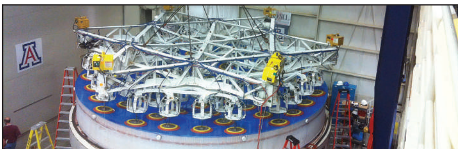
Podizanje primarno-tercijarnog zrcala za Simonyi Survey Telescope tokom testiranja u Richard F. Caris Mirror Lab-u pomoću vakuumskih držača. Plavi sloj je stavljen zbog zaštite zrcala.
