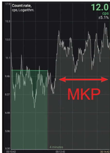
Detektor gama zraka na vreći umjetnog gnojiva MKP (monokalijev fosfat) i nagli skok u broju detekcija gama zraka kada se detektor približio vreći umjetnog gnojiva.
