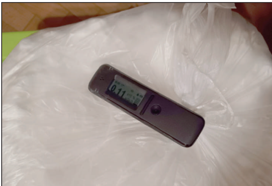
Detektor gama zraka na vreći umjetnog gnojiva MKP (monokalijev fosfat) i nagli skok u broju detekcija gama zraka kada se detektor približio vreći umjetnog gnojiva.
