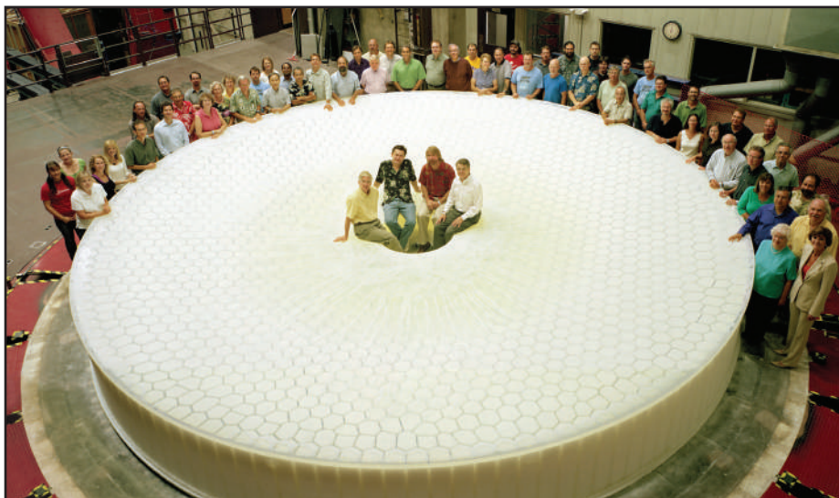
Primarno-tercijarno zrcalo za Simonyi Survey Telescope, nakon izlivanja u rotirajućoj peći u Richard F. Caris Mirror Lab-u u ožujku 2008. godine.
