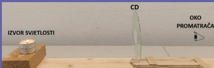
Postav pokusa – kroz postavljen CD (bez metalnog sloja) prolazi svjetlost s izvora (svijeće) do oka promatrača
