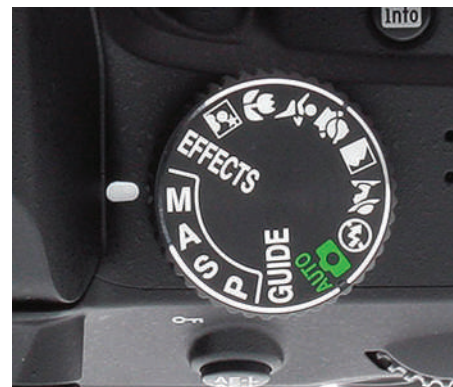
Prvi je korak aktiviranje ručnog načina rada, prebacivanjem prekidača na oznaku „M“.
