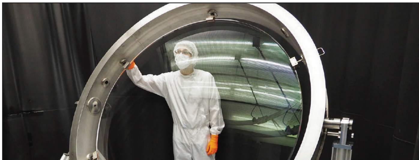
Ulazna leća za LSST kameru. S promjerom od 1,55 m to je najveća astronomska leća.
