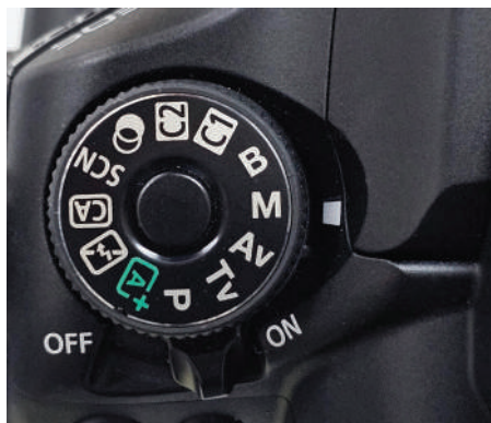
Prvi je korak aktiviranje ručnog načina rada, prebacivanjem prekidača na oznaku „M“.
