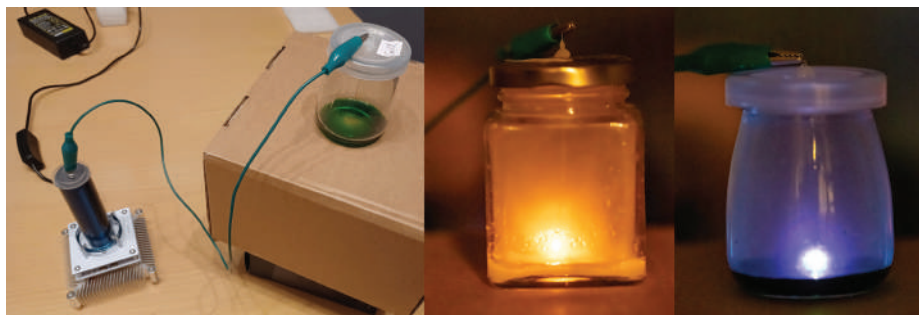
Korona izboj, pogonjen Tesliom zavojnicom, u atmosferi obogaćenoj natrijem (posuda koja sjaji narančasto) i bakrom (posuda koja sjaji plavo). Natrij se stvara iz mokre kuhinjske soli, a bakar iz otopine bakrovog klorida, na dnu zatvorene posude u kojoj je tanka žica na vrhu koje se stvara korona izboj.
