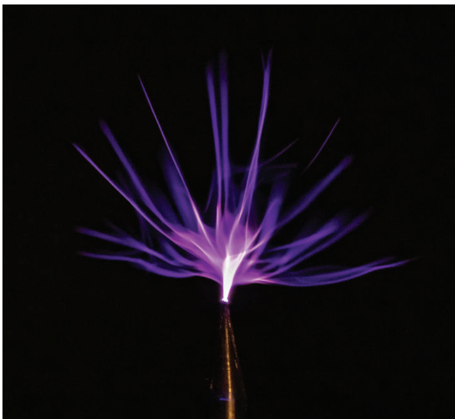
Korona izboj na šiljku spojenom na Teslinu zavojnicu. Ljubičasto-plavu boju emitiraju molekule dušika pobuđene sudarima s elektronima koji su ubrzani pomoću jakog električnog polja, foto Zoran Novak/AD Vega
