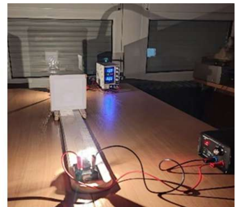
Fotometar za određivanje snage žarulje u školskim uvjetima
