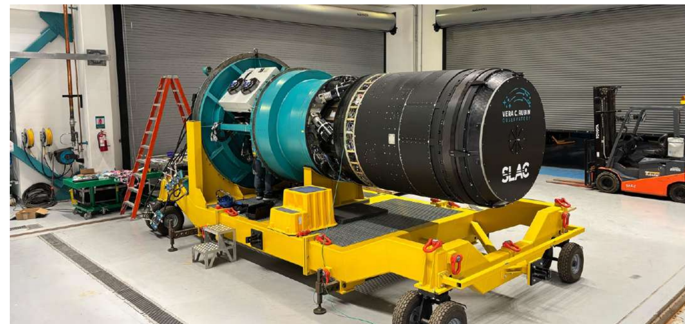
Slika 3: LSST kamera spojena je s obrtačem i spremna za završnu integraciju sa Simonyi teleskopom. U pozadini desno vidi se dizalo pomoću kojeg će kamera biti preseljena s 3. kata na slici do teleskopa na 8. katu zvezdarnice.
