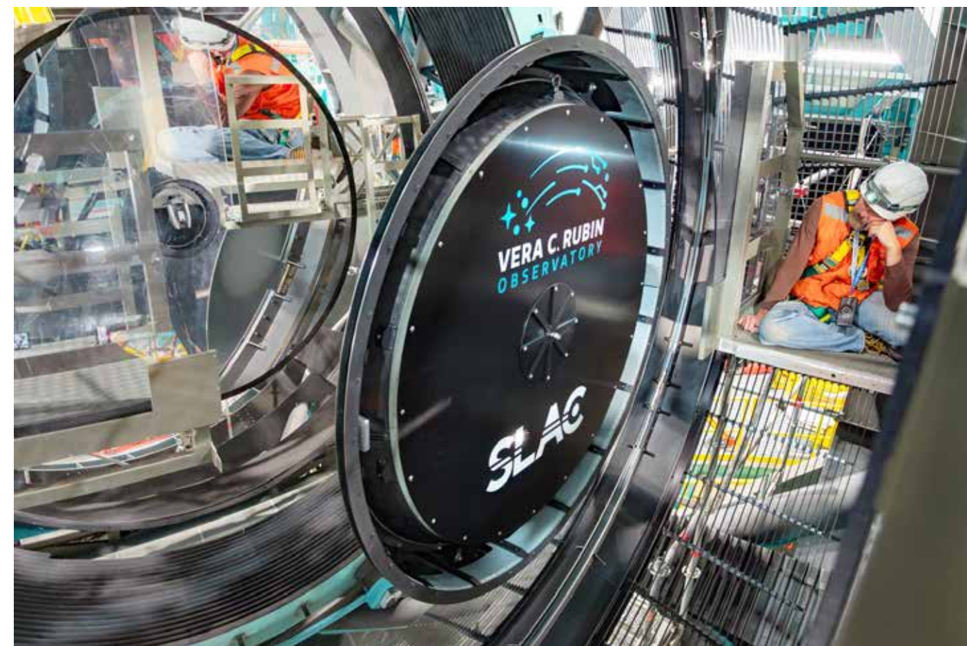
Slika 3: Nadzorni inženjer promatra prolazak kamere kroz otvor u centru sekundarnog zrcala.
