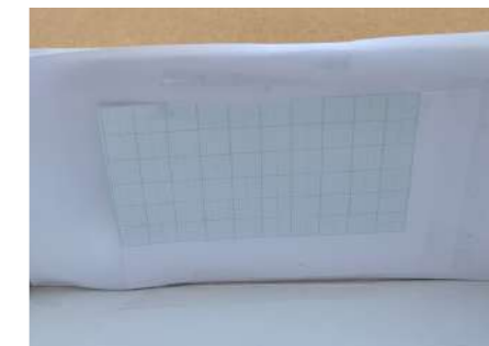
Milimetarski papir kao ekran na koji se projicira slika Sunca
