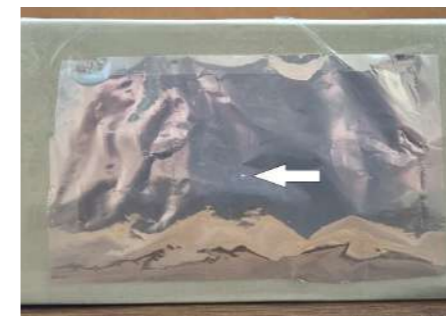
Rupica za projekciju Sunca načinjena iglom
