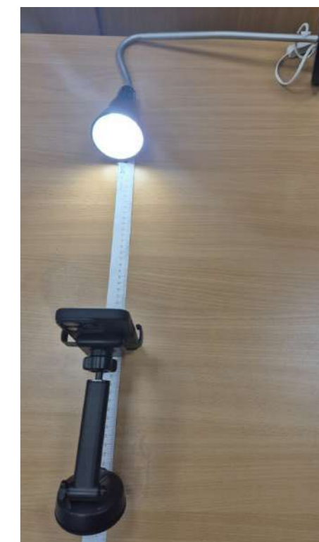
Eksperimentalni postav za mjerenje svjetlosnog toka pomoću pametnog telefona
