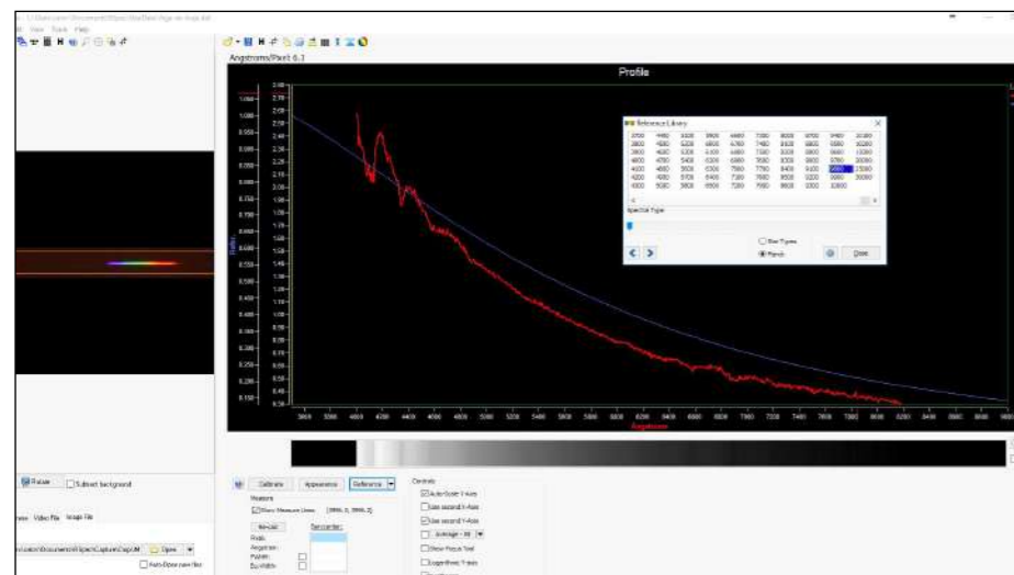
Slika 5. Izmjerena temperatura Vege bliska je stvarnoj vrijednosti
