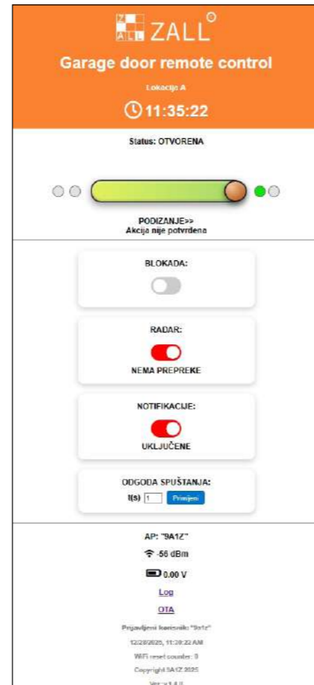
Sučelje kontrolera ESP32 daljinsko upravljanje garažnim vratima
