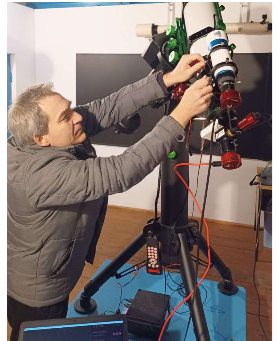
Usklađivanje vidnog polja spektroskopa s vidnim poljem teleskopa za vođenje.
